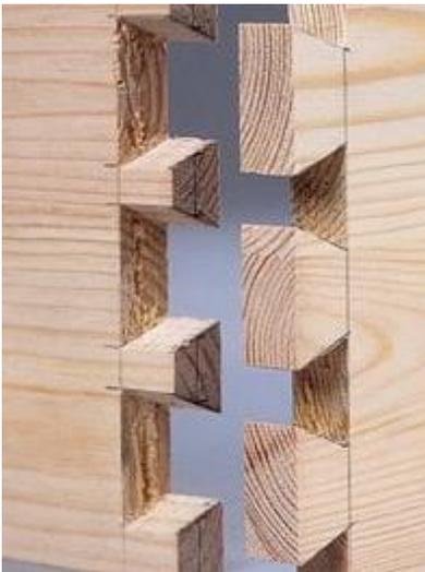
dann zusammensteckt. Dazu benutzte ich nicht die normale (Finger-) Verzinkung, sondern eine Spezielle; die Schwalbenschwanzverzinkung. Diese verhindert durch die Trapezform der Zinken, dass die Zinken auseinanderrutschen. Mit diesem Prinzip verzinkte ich eine Latte zu einem Rahmen.
